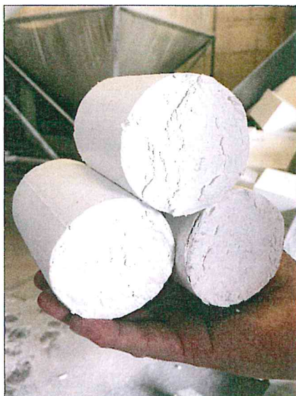
Kompaktierte EPS-Abfälle werden als Leichtzuschlag für Beton, Mörtel oder Estrich verwendet.
