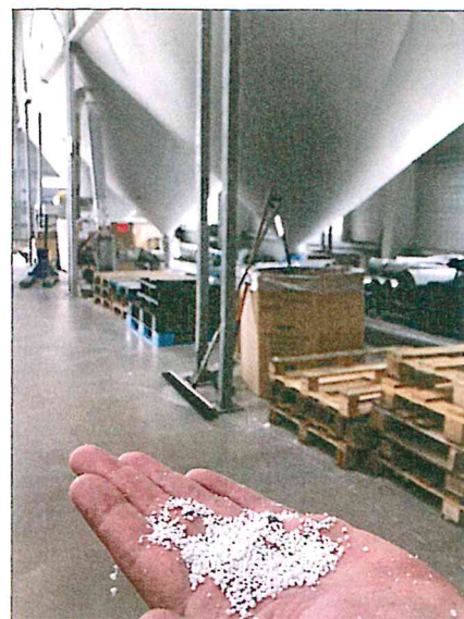
Aus EPS-Regranulat können neue Produkte wie Folien und Rohre entstehen.
