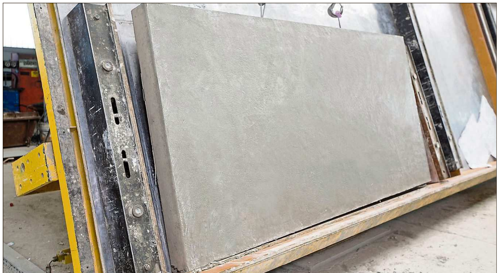
MC-FastKick erhöht die Ausschalfrequenz in Fertigteilwerken: Die neuen Erhärtungsbeschleuniger der MC-Bauchemie werden dem Beton während des Mischvorgangs hinzugefügt und beschleunigen den Erhärtungsprozess. Da damit hohe Frühfestigkeiten erreicht werden können, bietet MC-FastKick viele Vorteile für die Fertigteilindustrie sowie für Winterbaumaßnahmen.
